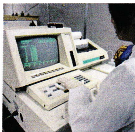
分光光度計で成分を分析 物質の濃度を測る「分光光度計」。ほとんどの研究室で用いられており、物質構造の分析などにも役立てられています。
